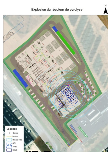
Figure 7: Cartographie des effets de l'explosion du réacteur de pyrolyse
