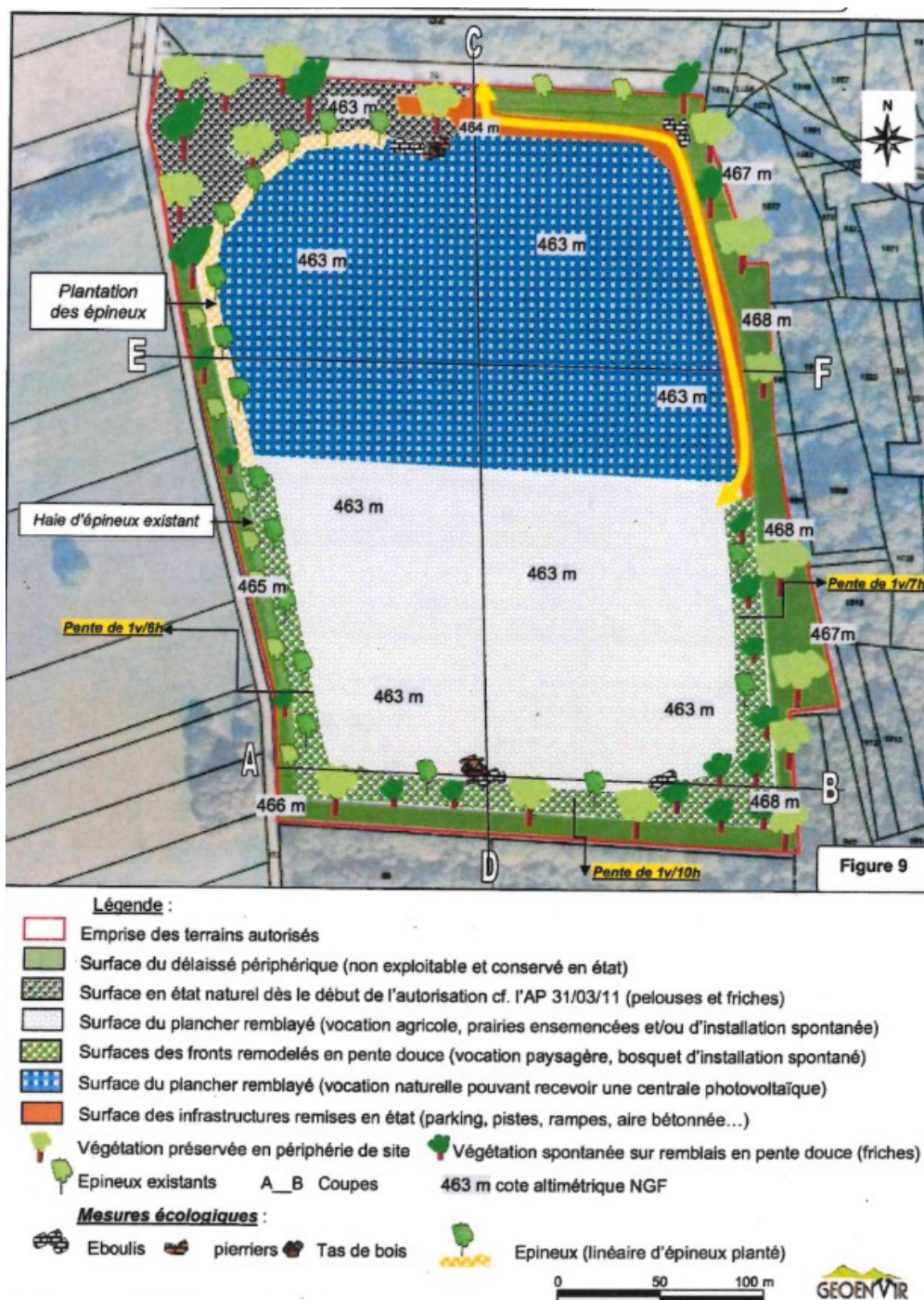
Illustration n°3 : schéma de principe du réaménagement de la carrière actualisé en 2024 et issu de l'arrêté préfectoral du 17 juin 2022 modifié.
