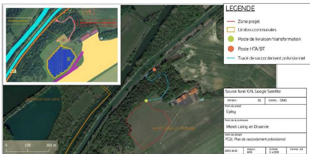
Illustration 2 - Tracé prévisionnel pour le raccordement au réseau (trait bleu). Le tracé suit la route d'accès au parking, en rose dans l'encart (modifié d'après p. 219, encart p. 196).
