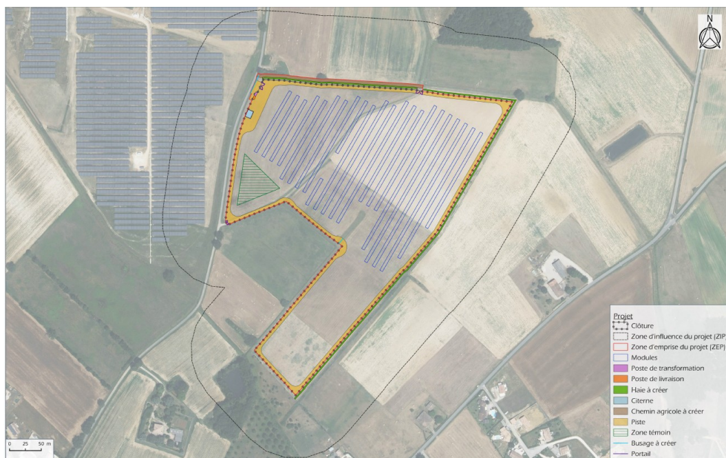
Figure 3 : plan de masse du parc photovoltaïque - extrait de l'étude d'impact p. 198
