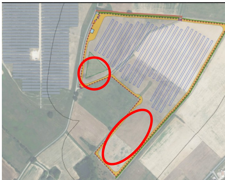
Figure 4 : plan de masse du parc photovoltaïque - extrait de l'étude d'impact p. 198
