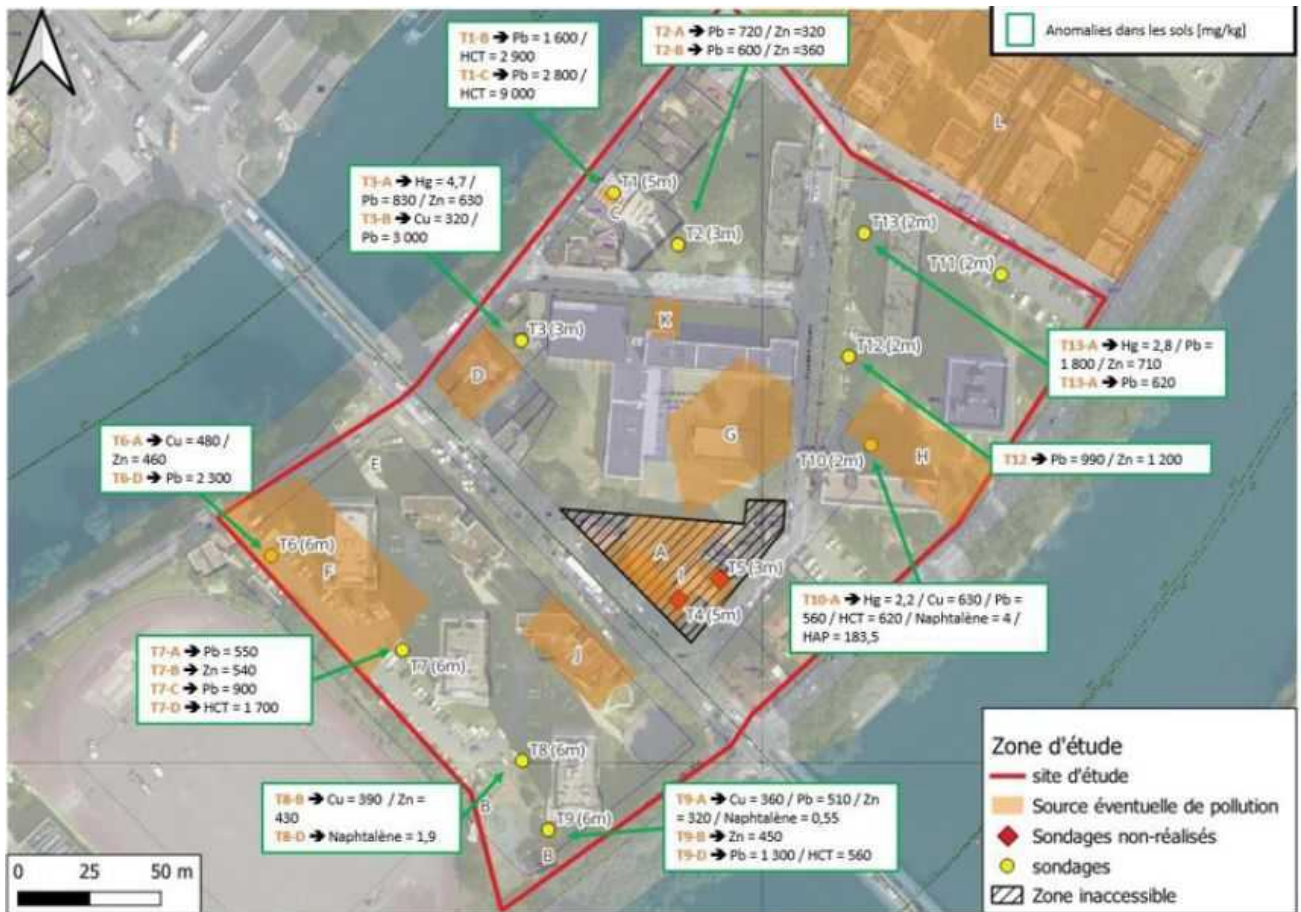
Illustration 7- Sources potentielles de pollution et sondages, indiquant les plus fortes anomalies analytiques (EI-P3, p. 36)
