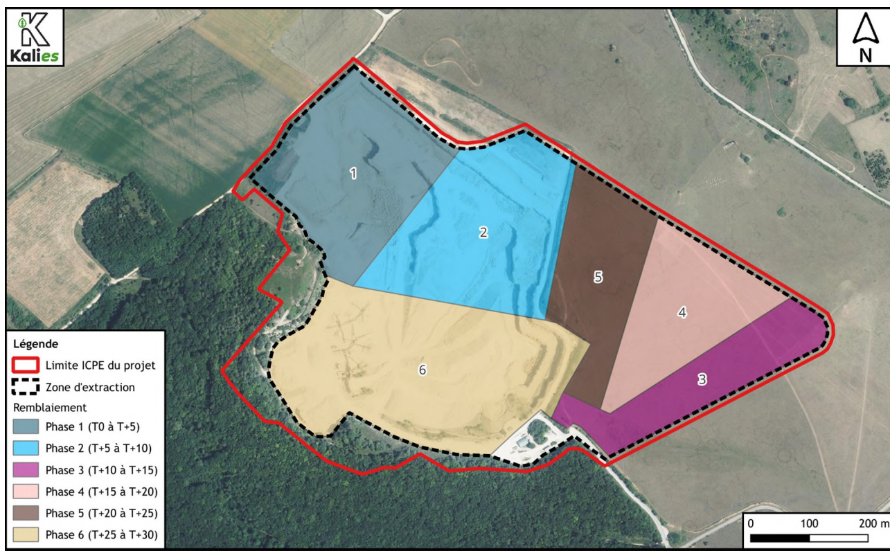
Figure 3bis : Principes de phasage de remblaiement
