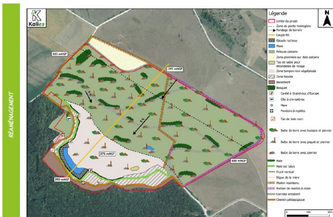
Figure 4 : plan de réaménagement de l'exploitation, modifié (merlon maintenu et portion de merlon à créer)
