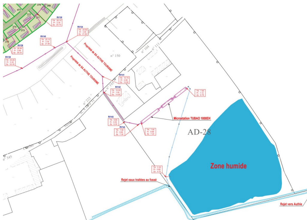
Parcelle sud avec la station d'épuration et le rejet à l'Authie (plan page 17 de la pièce PA2 du permis d'aménager)
